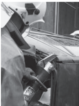
Mit Pionierwerkzeug und Fingerspitzengefühl wird das Verdeck des Unglückswagens weggeschnitten.
