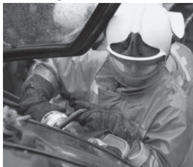
Mit Pionierwerkzeug und Fingerspitzengefühl wird das Verdeck des Unglückswagens weggeschnitten.
